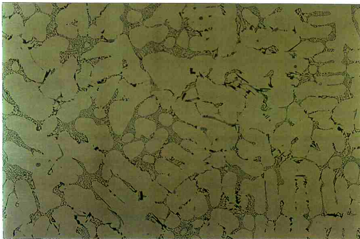
Figura 16 - Microestrutura típica de A356-T6, com 0,0065%Sr, sem ataque, 200x.
