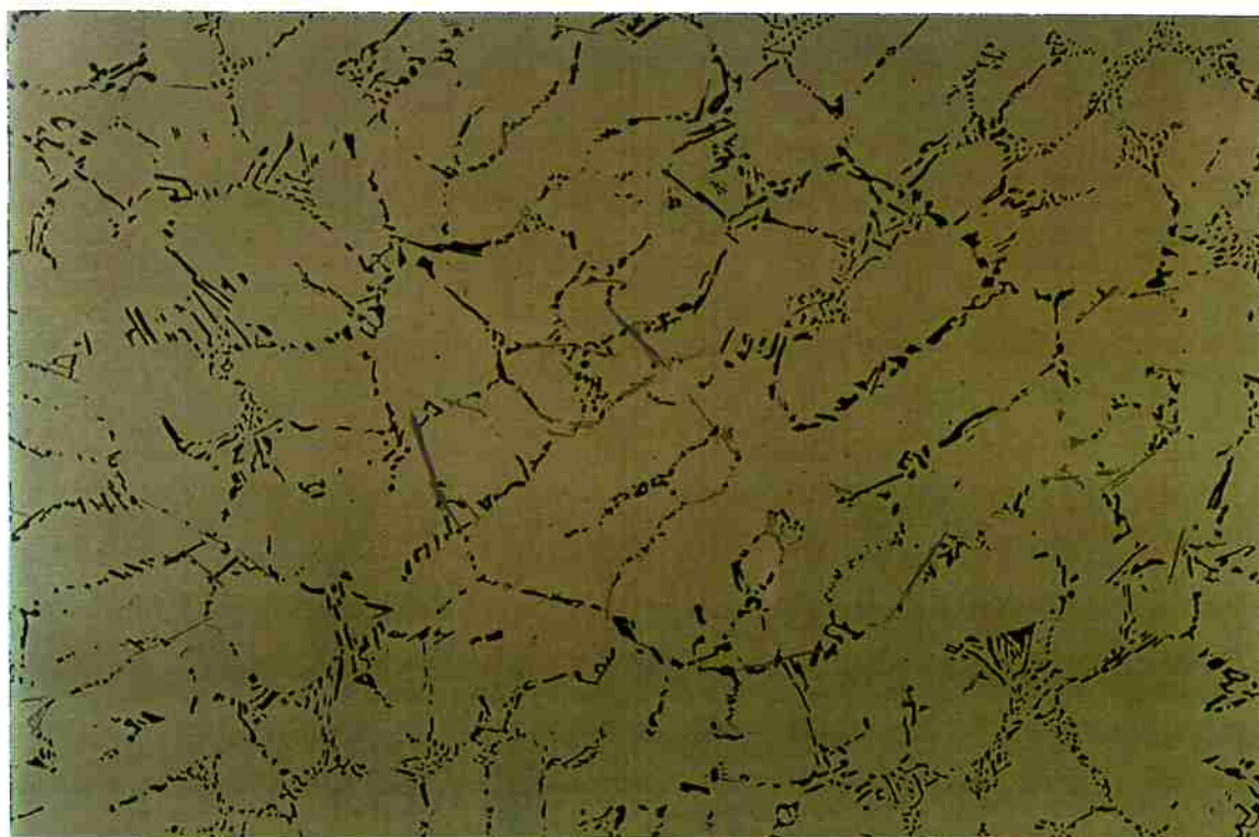
Figura 13 - Microestrutura típica encontrada em liga A356 com 0,0089%Sr, bruta de fusão, sem ataque, 200x.
