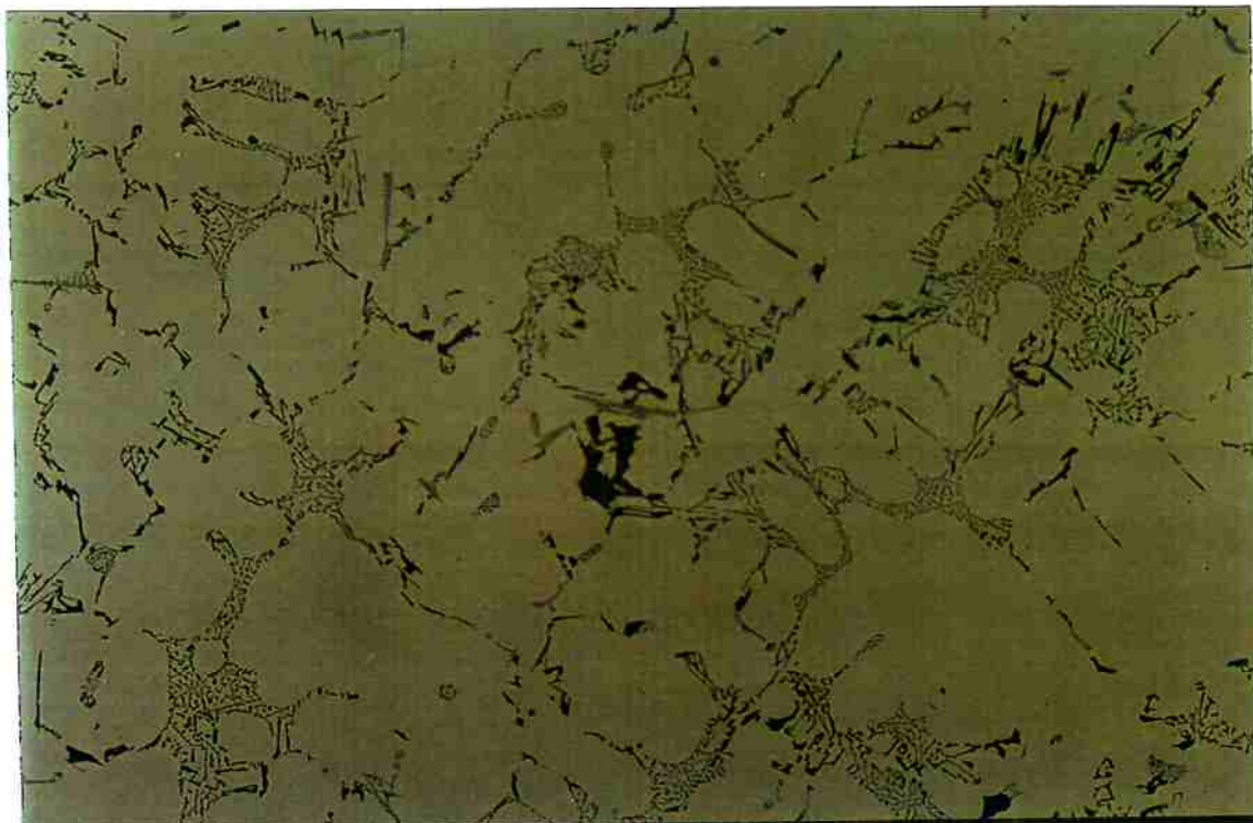
Figura 12 - Microestrutura típica encontrada na liga A356 com 0,0065% Sr, bruta de fusão, sem ataque, 200x.
