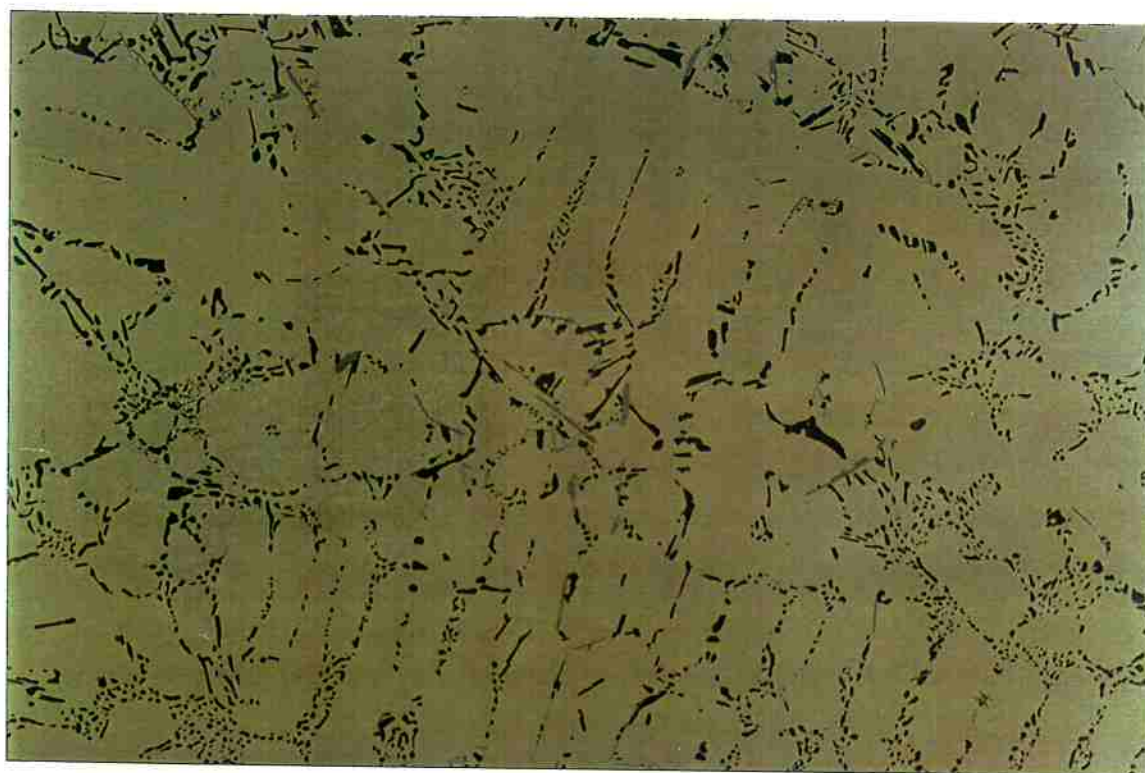
Figura 17 - Microestrutura típica de A356-T6, com 0,0089%Sr, sem ataque, 200x.
